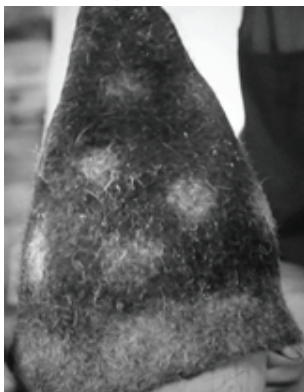
Obr. 3. Štump na kužeľovitej drevenej klobučníckej forme pripravený na ďalšie tvarovanie
